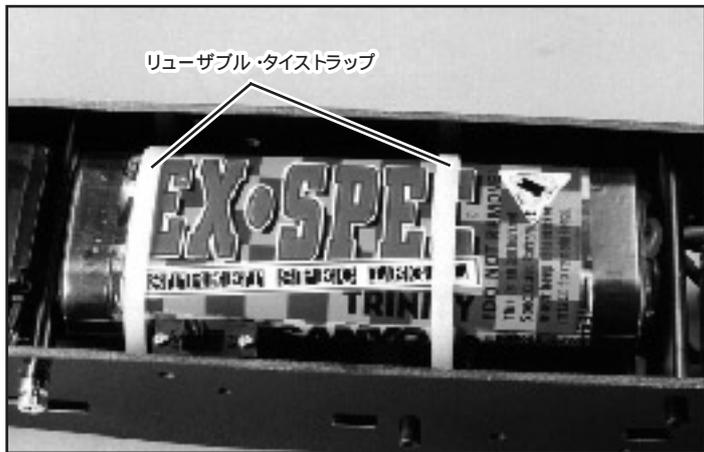
STEP 17 シャーシを裏返し、バッテリーを取り付けます。取り付けには付属のリユーズブル・タイストラップ2本を使用して下さい。それからスイッチをサーボテープでバッテリーの隣、またはサーボの隣(ワイヤーの長さが十分にある場合)に貼り付けて下さい。これでボディを外す事なくスイッチのオン/オフを行えます。なお、スイッチのワイヤーがバッテリーに接触しないように気を付けて下さい。
