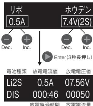
画面上段、左側に放電するバッテリーの種類、画面下段、左側には放電電流、右側にはセル数が表示されます。(Enter)ボタンを押す事に選択項目が移動しますので、(Dec.)/(Inc.)ボタンでそれぞれの数値を設定することができます。設定が完了したら(Enter)ボタンを3秒間長押しする事で放電が開始されます。
