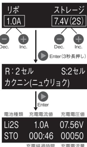
画面上段、左側には充電するバッテリーの種類、画面下段、左側には充電電流、右側にはセル数が表示されます。(Enter)ボタンを押す事に選択項目が移動しますので、(Dec.)/(Inc.)ボタンでそれぞれの数値を設定することが可能です。設定が完了したら(Enter)ボタンを3秒間長押しする事で充電が開始されます。
