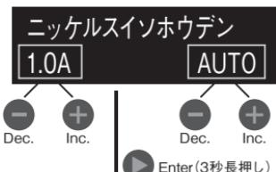
電池種類 放電電流値 放電終止電圧値
