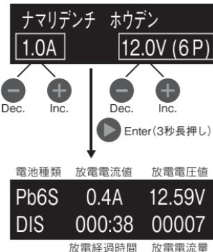
画面上段、左側に放電するバッテリーの種類、画面下段、左側には放電電流、右側にはセル数が表示されます。
