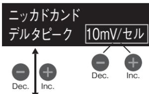
ニッカドバッテリーのデルタピーク感度を設定します。
