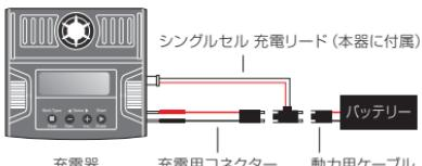
\*シングルセル充電リードは充電器コードと動力用ケーブルの間に接続しリードから出ているバランスケーブルを充電器に接続してください。
