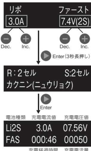
画面上段、左側には充電するバッテリーの種類、画面下段、左側には充電電流、右側にはセル数が表示されます。(Enter)ボタンを押す事に選択項目が移動しますので、(Dec.)/(Inc.)ボタンでそれぞれの数値を設定することが可能です。設定が完了したら(Enter)ボタンを3秒間長押しする事で充電が開始されます。
