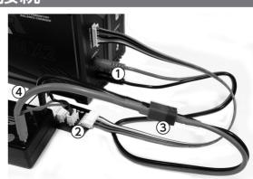
①充電用コネクター T型2ピンを充電器に接続します。 ②バッテリーのバランスコネクターを本体から延長したバランスボードに接続します。 (リチウム系バッテリーを充電する場合は、バランスコネクターを必ず接続してください。リチウム系以外のバッテリーではバランスコネクターを使用しません。) ③バッテリーのコネクターを充電用コネクターT型2ピンに接続します。(バッテリーのコネクター形状が違う場合は付属の変換アタッチメントを使用してください。)充電終了時は③→②の手順で取り外します。 ④のコードは付属してません。別途購入されるかバッテリー付属品をご利用ください。【※注意】バッテリーがつながったまま①を最初にぬくと非常に危険。端子同士でショートして発火などおこります。
